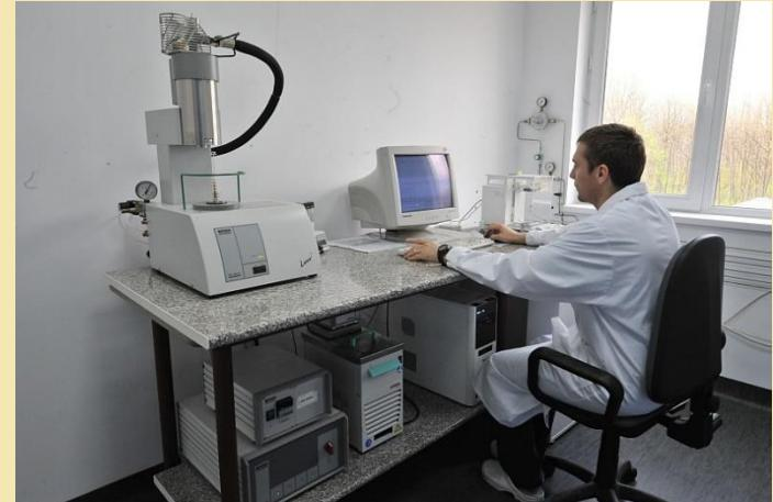
Echipament pentru Analiza Termica Simultana STA 409 PC Luxx, Netzsch Geratebau GmbH;
